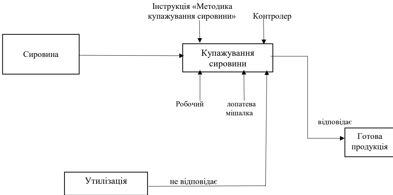
Схема 4.10 - Структурно-функціональна схема процесу купажування сировини
