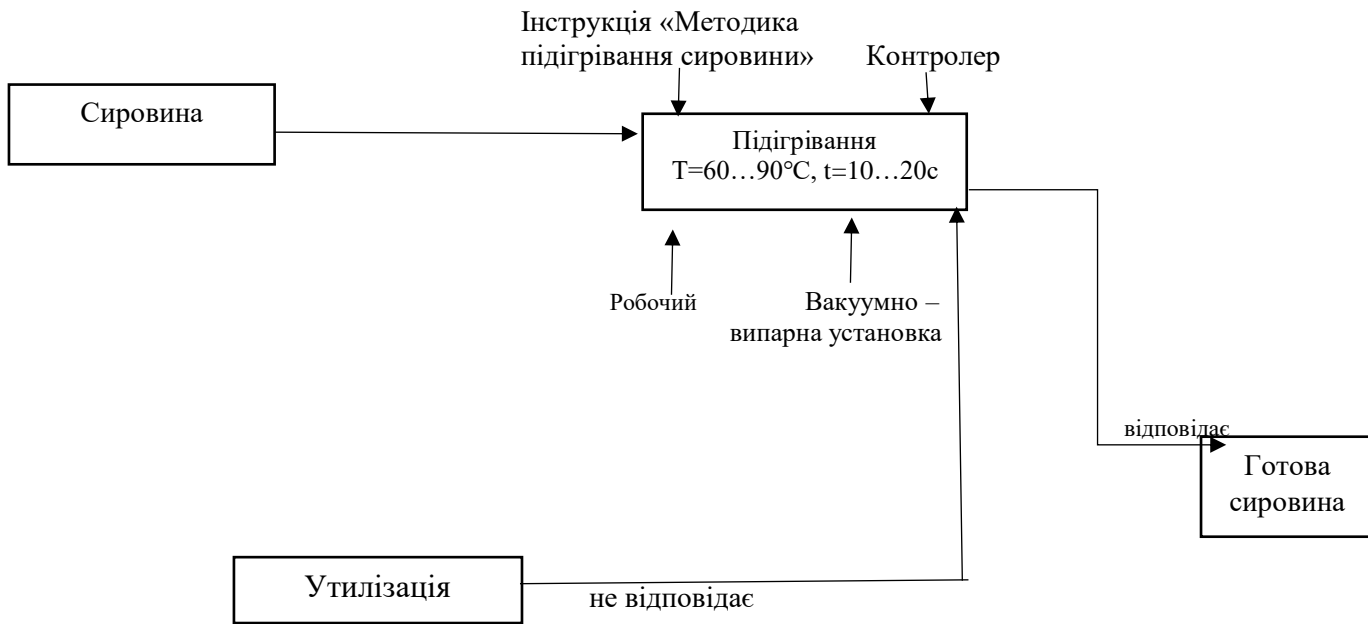
Схема 4.8 - Структурно-функціональна схема процесу підігрівання сировини
