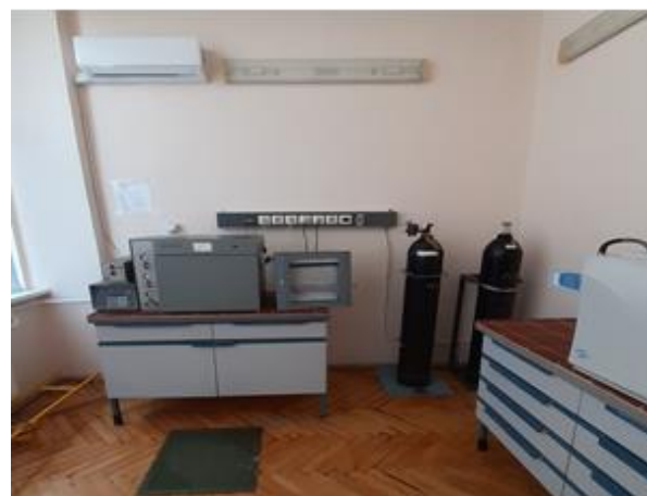
Рис. 2. Газовий хроматограф ЦВЕТ-500М з температурою випарника 70°C, температура колонки 35°C, температура детектору 280°C, витрата газу-носія 40 см 3 /хв.
