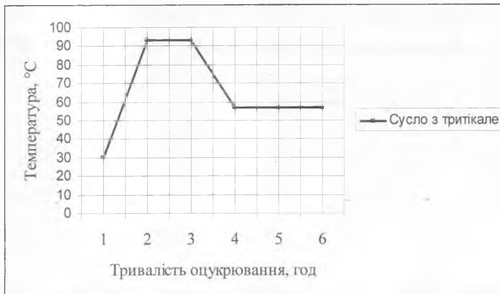
Рис. 3. Технологічний режим приготування сусла з тритікале
