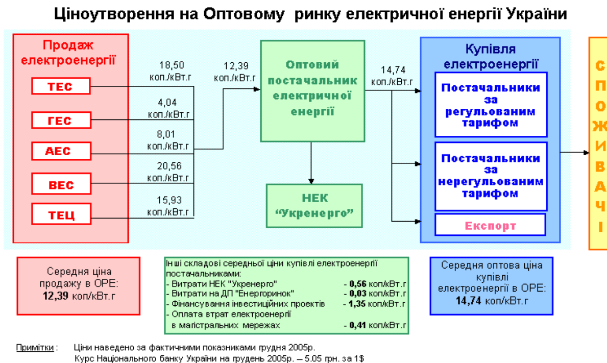
Рис. 4. Схема процесу ціноутворення на Оптовому ринку електричної енергії України розрахунковими періодами від «Start» до «End», тобто з 6 00 до 23 00 .
