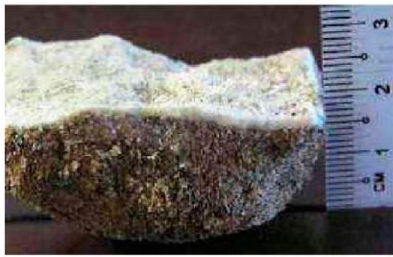
Рис. 2. Твердий поверхневий шар біоцементу на поверхні піску: рівень біоцементуючого розчину тримався над поверхнею ґрунту.
