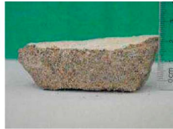
Рис. 3. Глибинна біоцементатція піску: рівень біоцементуючого розчину тримався нижче поверхні піску.
