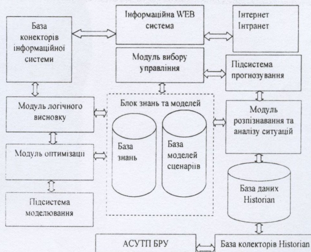
Рис. 2. Структура системи автоматизованого управління БРУ на основі сценарного підходу.
