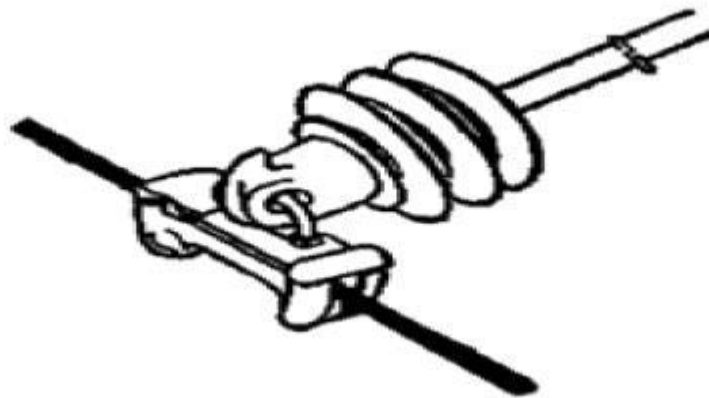
Рис. 14.5. Конструкція дугогасного затиску, розробленого у Фінляндії
