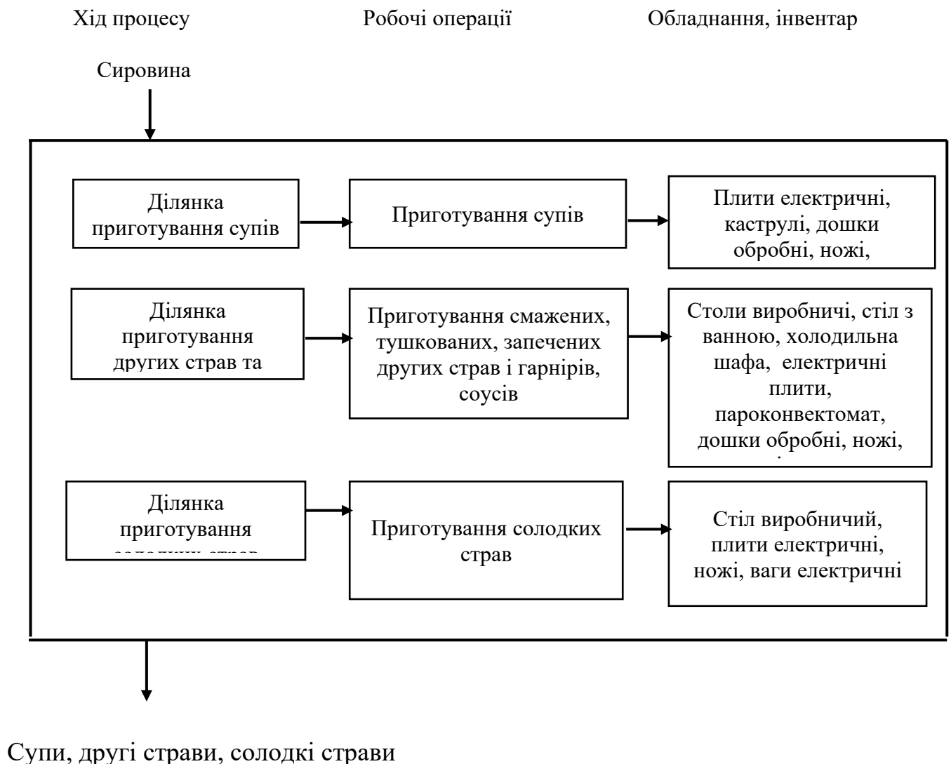
Рисунок 3.4 - Структурно-технологічна схема виробничого процесу гарячого цеху
