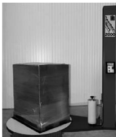
Рисунок 1.6. Машина для стретч плівки з поворотною платформою та ручним направленням плівки
