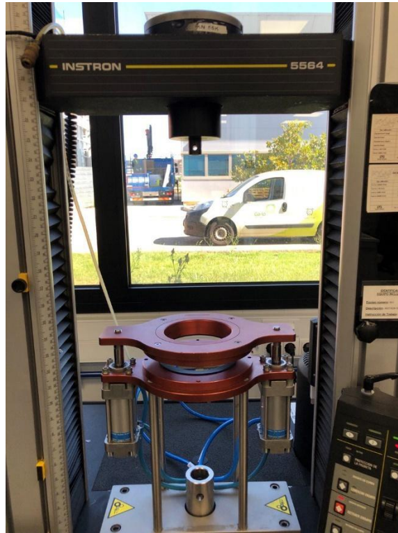
Рисунок 3.7. Машина Instron 5564 для визначення міцності на прокол
