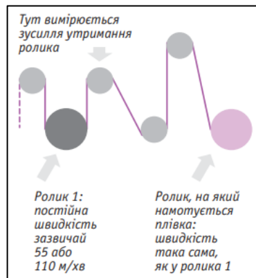
Рисунок 3.5. Схема обладнання Highlight Ultimate при визначенні міцності на прокол
