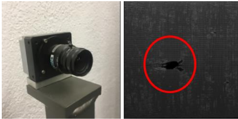
Рисунок 3.4. Високошвидкісна камера та вигляд дефекту при деформації плівки
