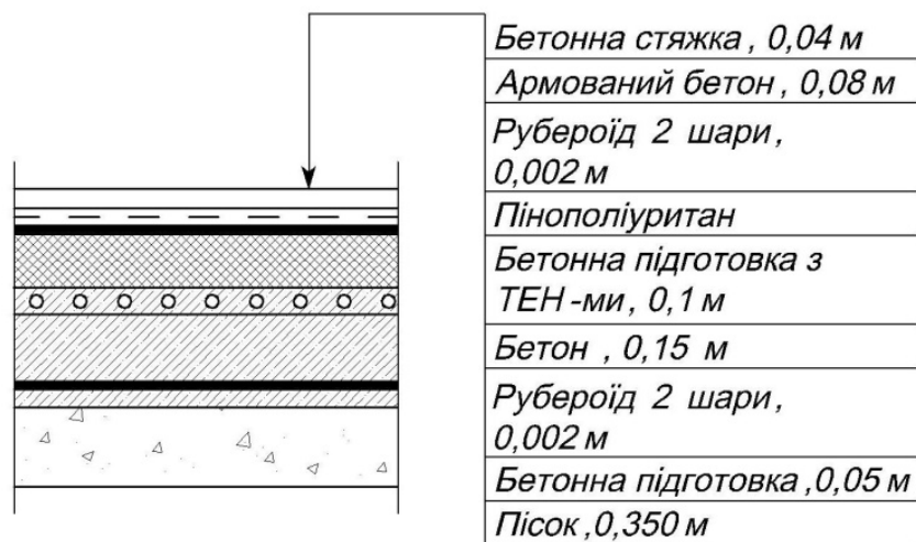
Рисунок 2. Будівельних шарів підлоги.
