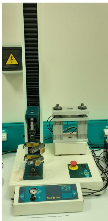
Рисунок 3.2 Загальний вигляд універсальної машини Tinius Olsen H5K-T Розривна машина Tinius Olsen H5K-T складається з напрямної колони, траверси, пульта управління, нижнього та верхнього захватів.
