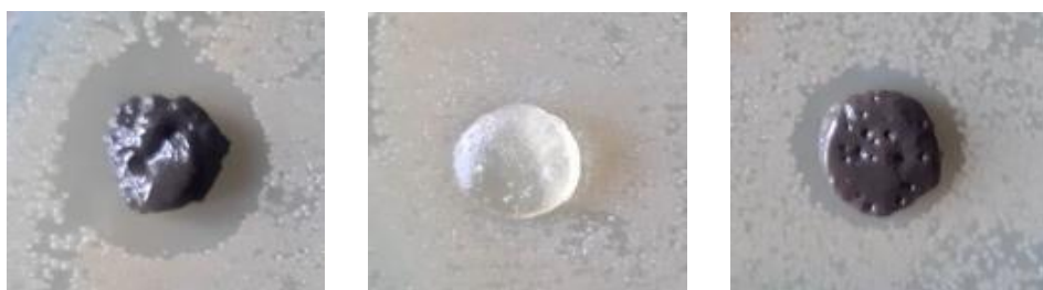
Рис. 6. Антимікробна активність гідрогелевих матеріалів на основі: ПВС-ПЕГ, наповнених 1% мас. Ag (а), 1% мас. ZnO (б), 1% мас. Ag/ZnO (в) щодо мікроорганізму E. coli
