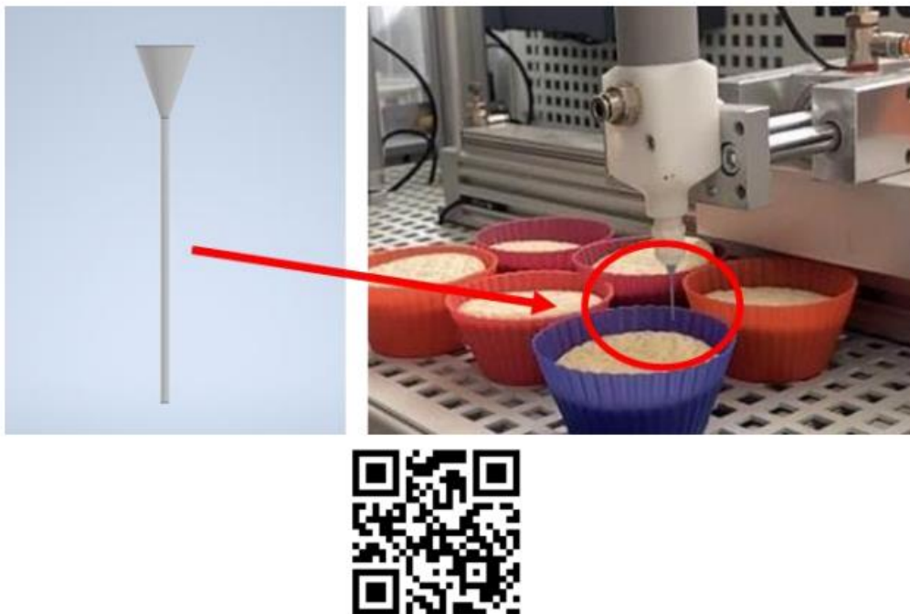
Рис. 2.1.1. Накладання на реальний об'єкт (дозатор) гнучкої насадки повністю виготовленої з поліпропілену з портом подвійної спіралі Luer Lock.
