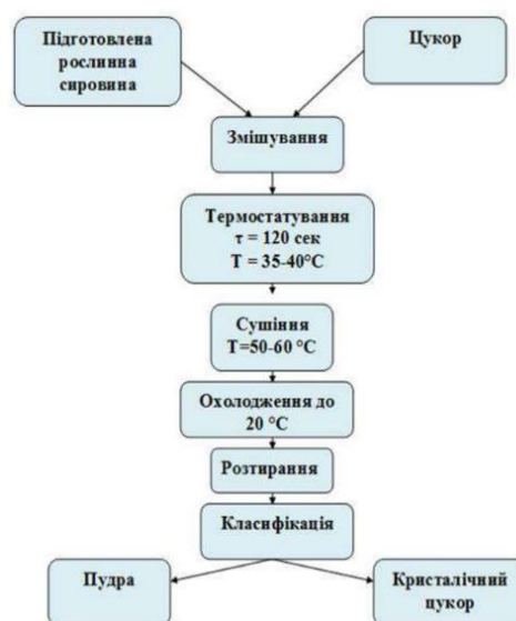
Рисунок 1.1 - Принципова схема одержання цукру з підвищеною біологічною цінністю за І. Гріненком
