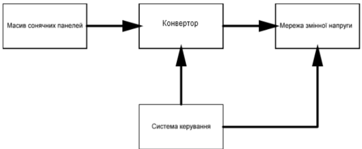
Рис. 20. Структура системи електроживлення з використанням сонячних батарей у якості первинного джерела енергії
