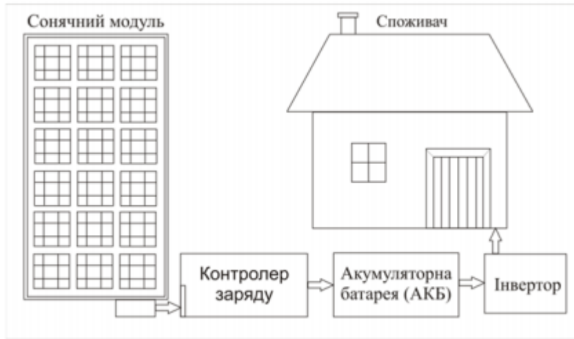
Рис. 15. Схема автономної системи електроживлення
