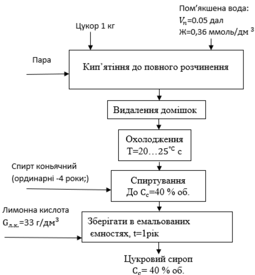
Рис. 2.3 Принципова технологічна схема виготовлення цукрового сиропу
