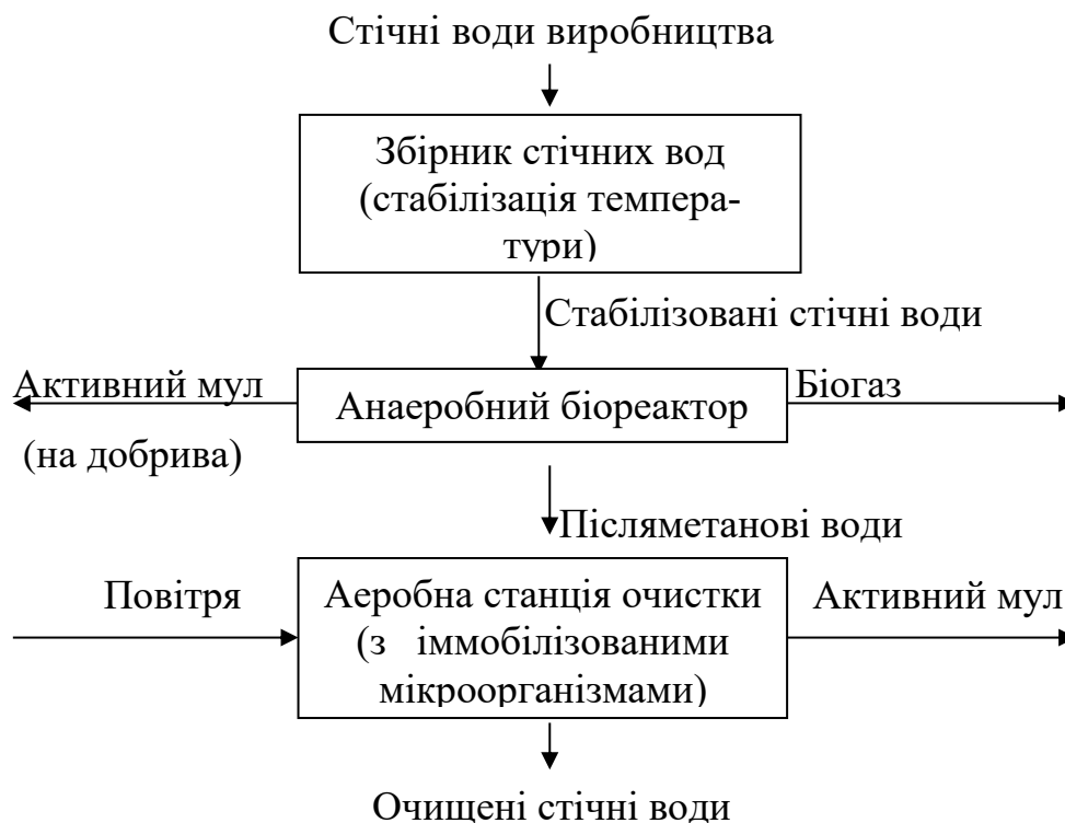
Рис.12.1 – Принципова технологічна схема двостадійної очистки стічних вод
