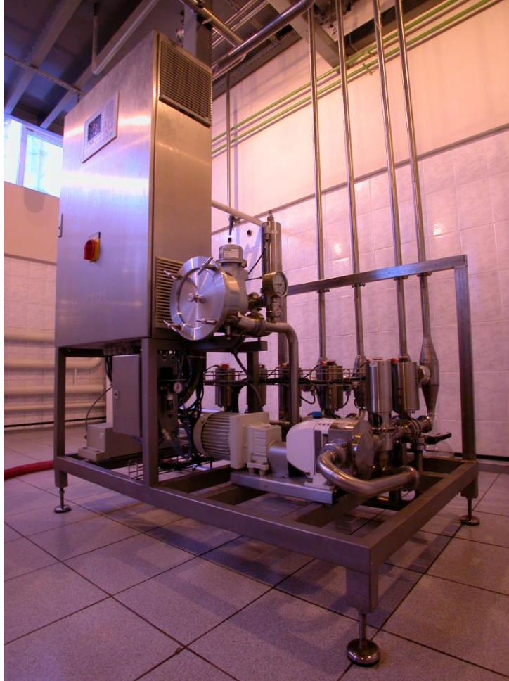
Рис. 2.5 – Блок управління установкою змішування інгредієнтів у потоці
