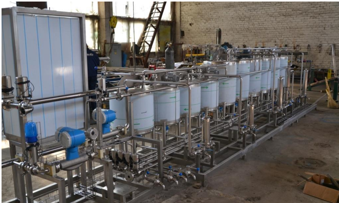
Рис. 2.6 – Дозуючі елементи установки для змішування інгредієнтів
