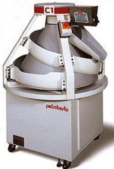
Рис. 1.7.4. Тістоокруглювач конічний Pietroberto модель C1.
