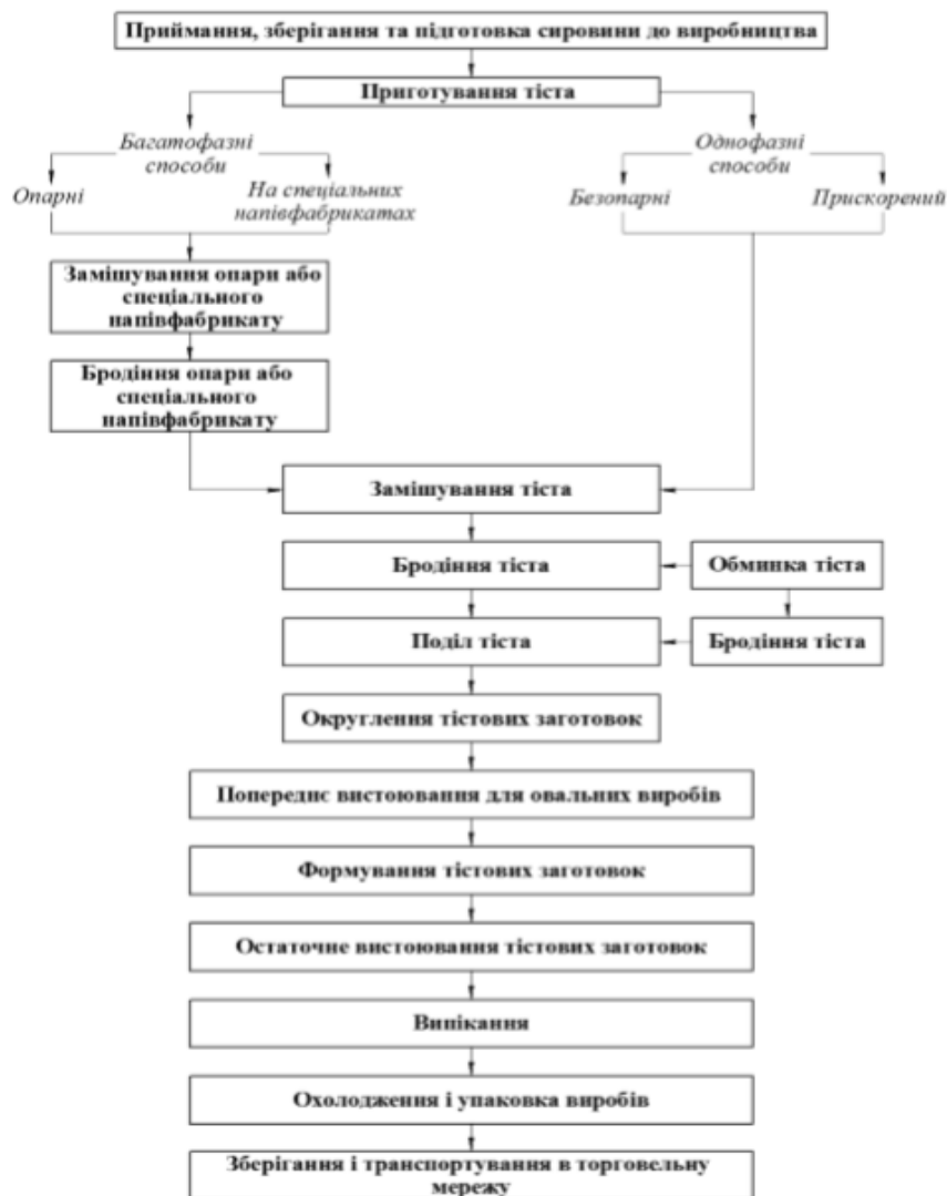
Рис. 1.1. Технологічна схема виготовлення хлібобулочних виробів
