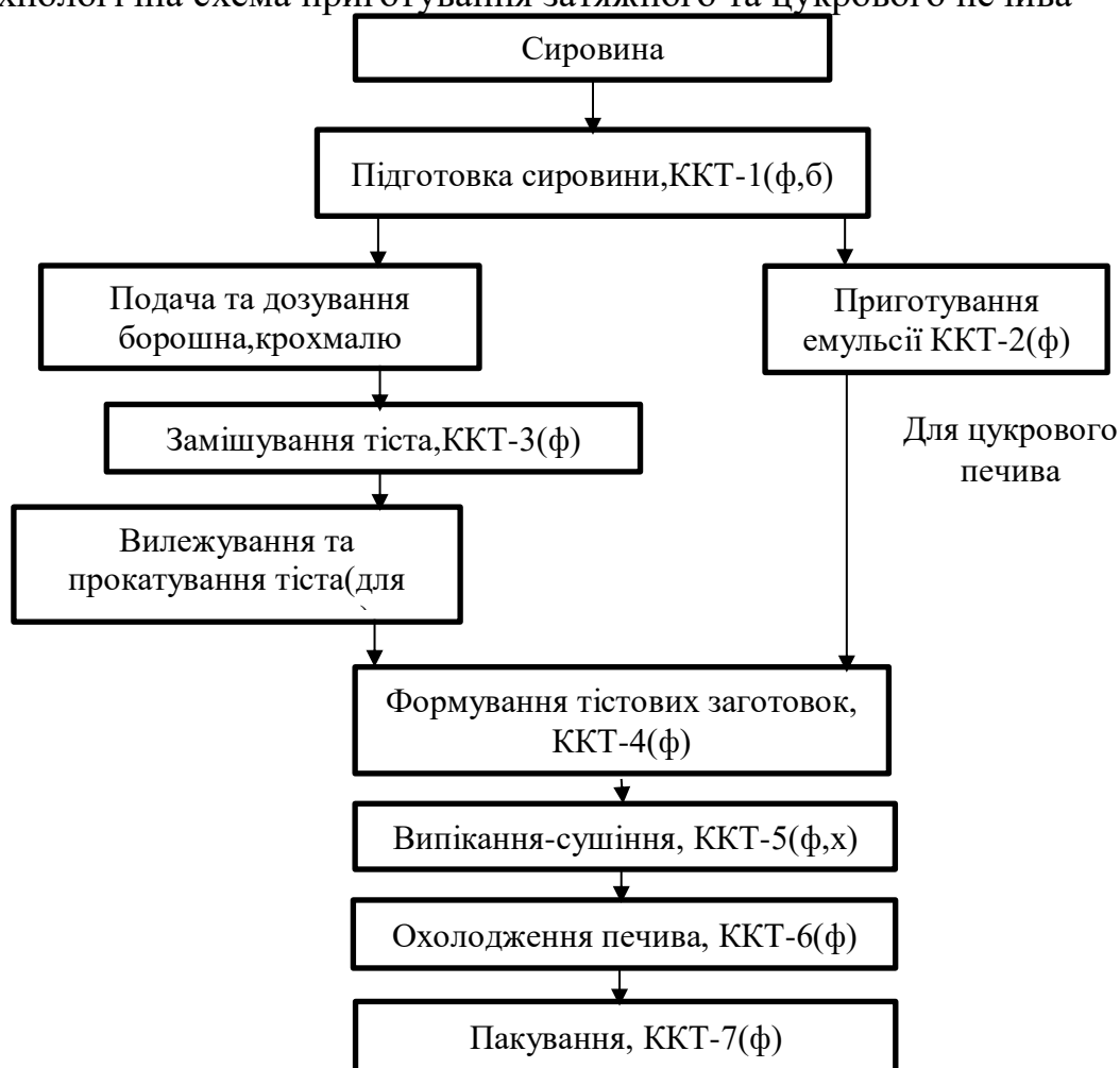
Рис.9.2- Принципова схема виробництва цукрового та зтяжного печива із зазначенням ККТ
