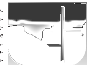
Рис.4. Розподіл концентрації суміші після 21-ої секунди змішування
