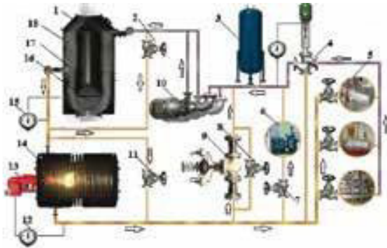
Рис. 1.7. Схема термомасляної циркуляційної системи
