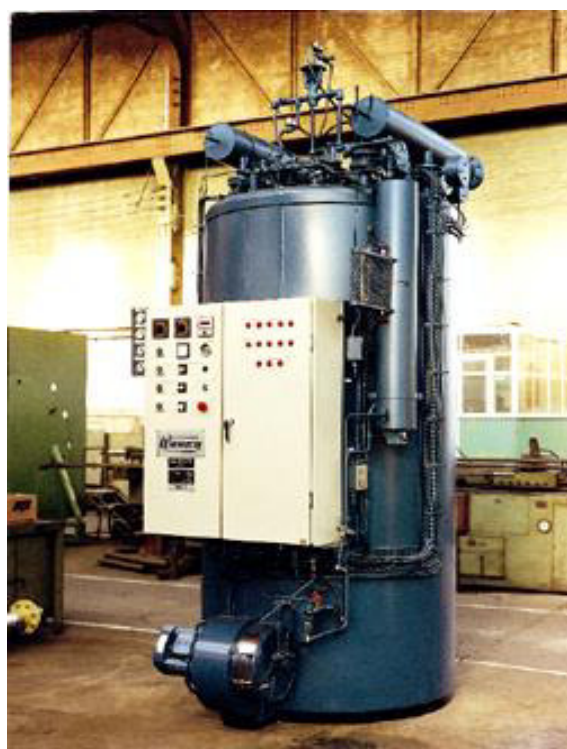
Рис. 1.5. Вертикальна компоновка термомасляного котла
