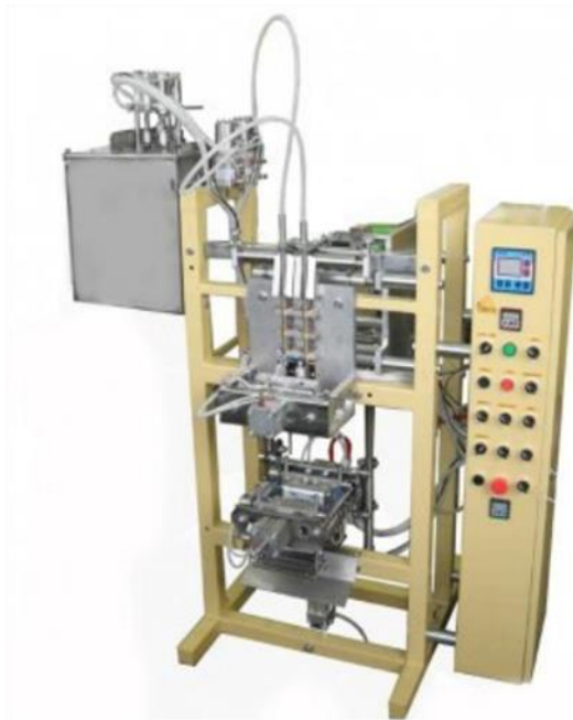
Рис. 1.1.3. Машина ІН-ПЗ призначена для пакування у пакет саше
