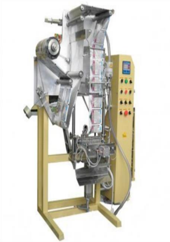
Рис. 1.1.2. Машина ІН-ПЗ упаковка в'язких продуктів в пакет саше
