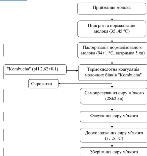
Рис. 1.3.5 - Технологічна схема виробництва сиру м'якого з коагулянтном "Kombucha"
