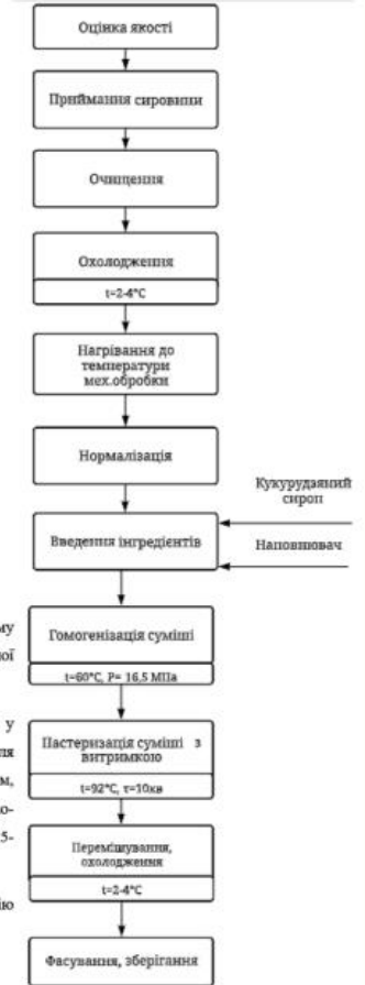
Рис. 7 Технологічна схема виробництва молочного напою з кукурудзяним сиропом HFCS
