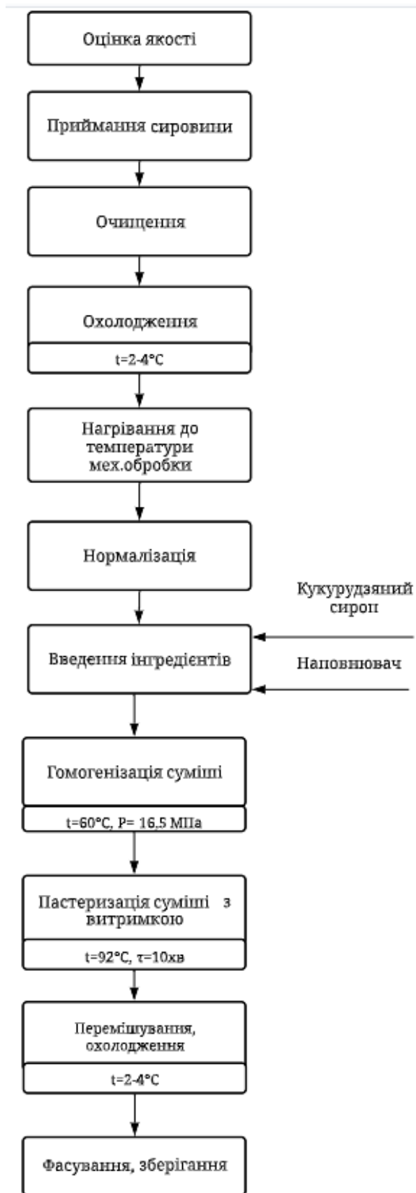
Рис. 1.10. Технологічна схема виробництва молочного напою з кукурудзяним сиропом HFCS
