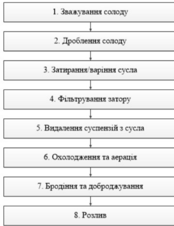
Рис. 2.2. Схема технологічного процесу виготовлення пива
