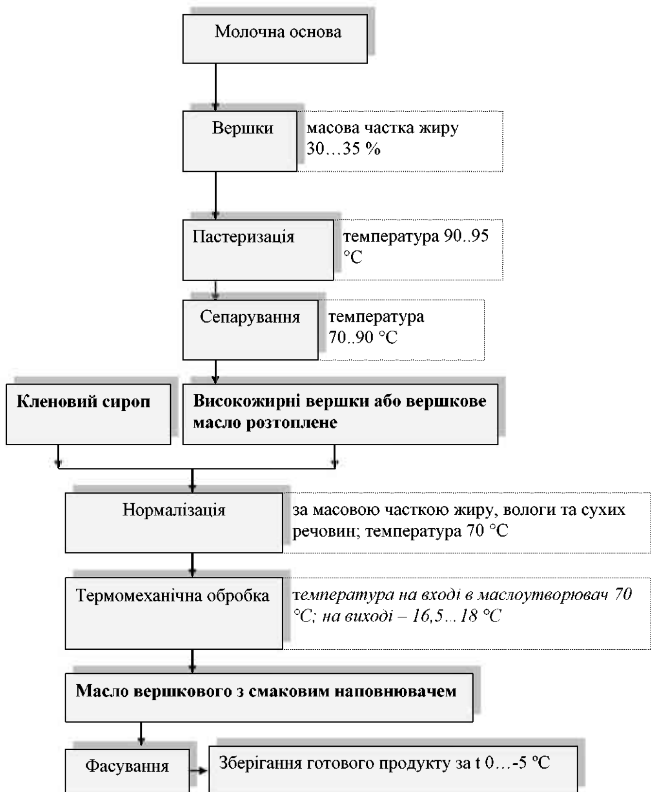
Рисунок 1.3.3. - Параметрична схема виробництва масла вершкового з смаковим наповнювачем
