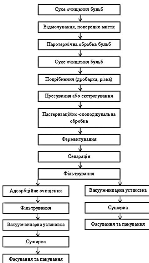
Рис. 3.1.1.1. Технологічна схема отримання порошку топінамбура
