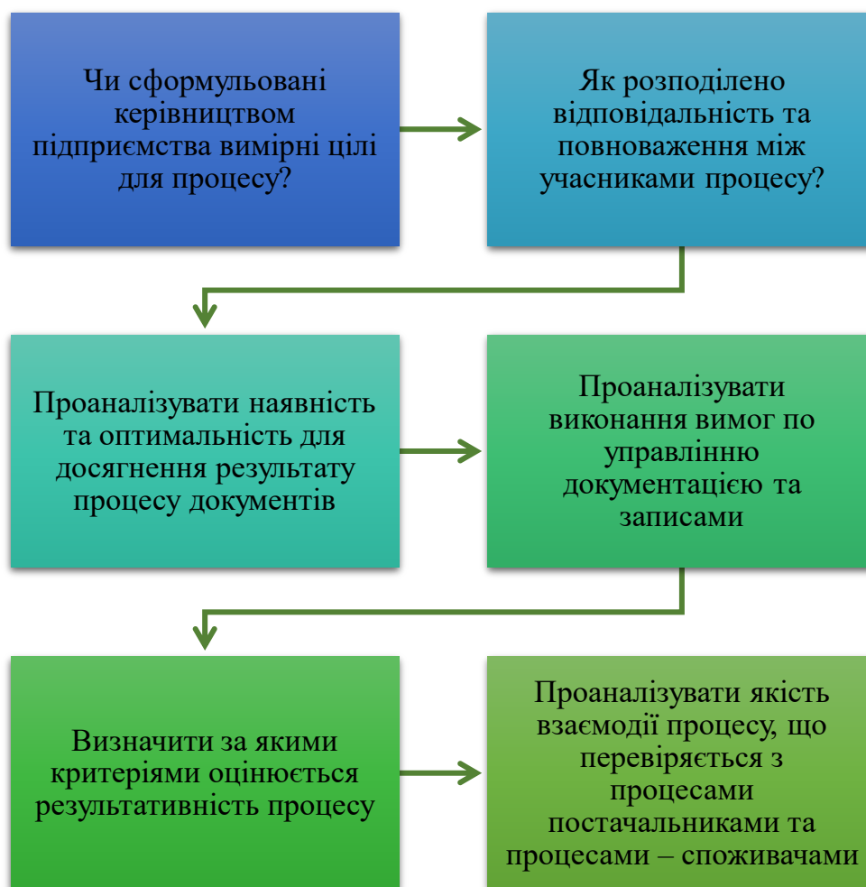
Рисунок 1.3 – Критерії проведення внутрішньої перевірки виробничого процесу
