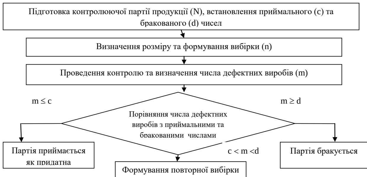
Рис. 1. Схема багаторівневого приймального контролю якості продукції
