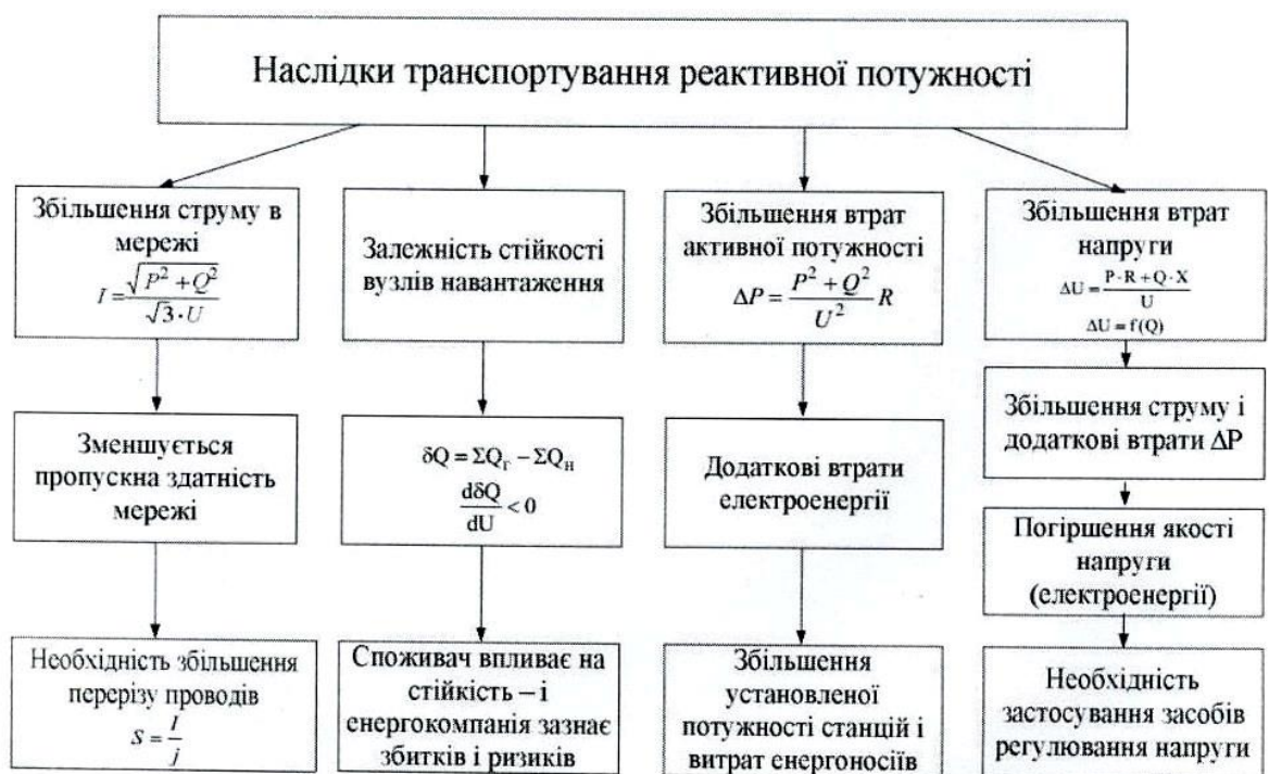
Рис. 12.1. Вплив реактивної потужності на роботу електричних мереж
