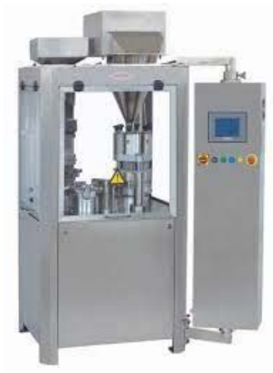
Рис 1.4 - Автомат для наповнення твердих ЖК К4-120
