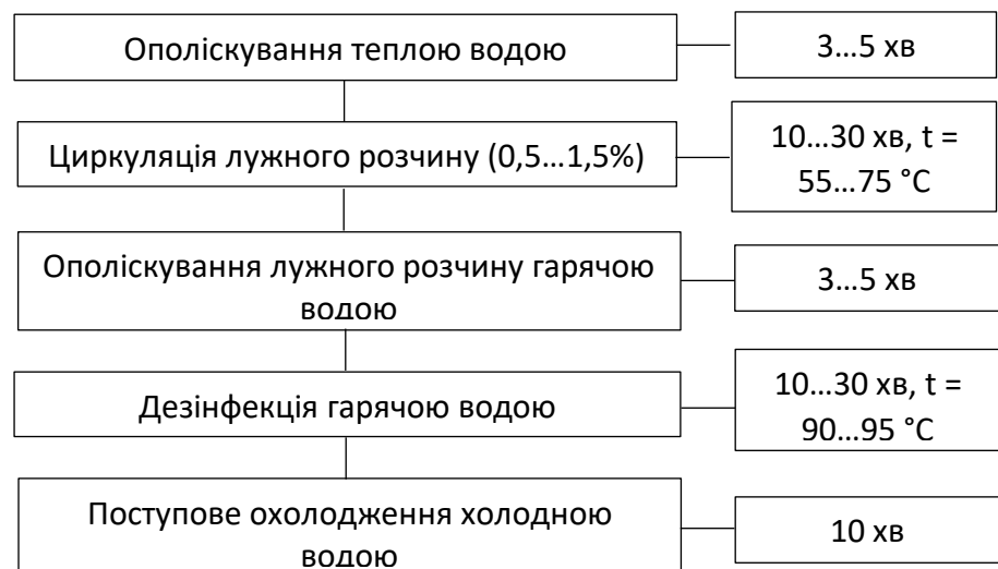
Рис. 2.3. Схема миття програми СІР «холодних елементів»
