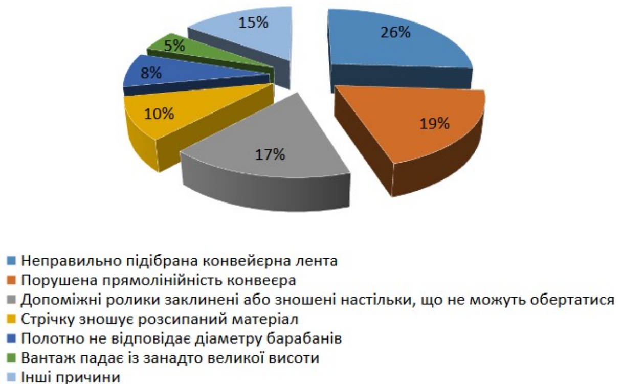
Рис. 4.1 Діаграма основних причин зношення конвеєрних стрічок
