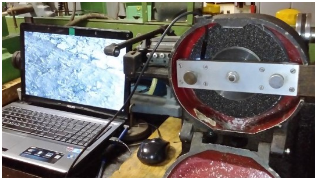
Рис 3.18 науково дослідному стенді МІ-2 з можливістю відео фіксації
