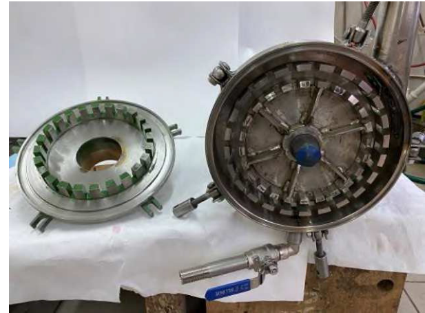
Рис. 4. Зовнішній вигляд роторно-пульсаційного апарата (РПА)
