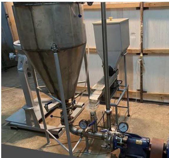
Рис. 3. Ємність для сировини з вібродозатором
