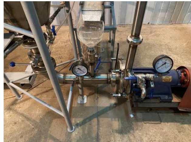
Рис. 5. Зовнішній вигляд РПА, підшипникового та сальникового вузлів
