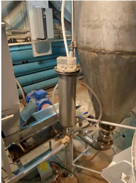
Рис. 2. Проточний водонагрівач з контролером регулювання температури
