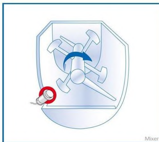
Рисунок 4.5 – Установка датчика Wile 55 для вимірювання вологості в міксері
