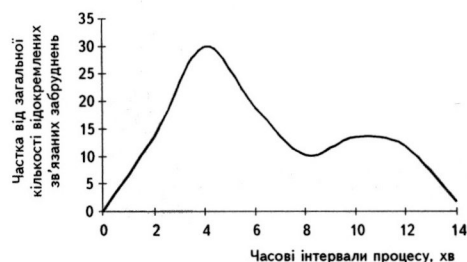
Рис. 4. Діаграма інтенсивності процесу відмивання при використанні активаторів із гладкими поверхнями
