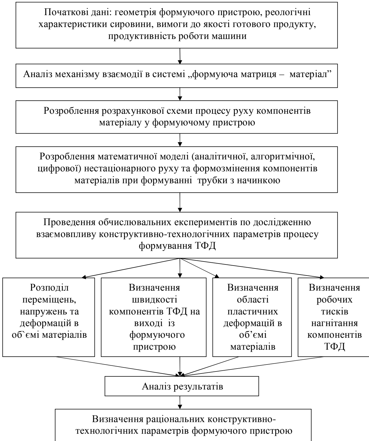
Рис.1. Схема визначення раціональних конструктивно-технологічних параметрів формуючого пристрою
