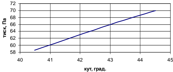
Рис.12. Залежність тиску нагнітання матеріалу оболонки від кута матриці
