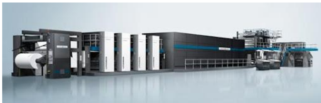
Рис.4.3.4 - офсетна друкарська машина Manroland Lithoman
