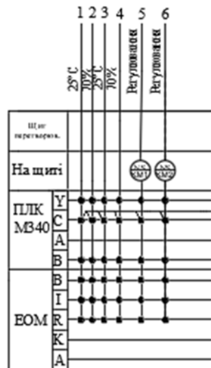
Рисунок 3.3.1 Функціональна схема автоматизації контуру регулювання температури та вологості повітря в теплиці.
