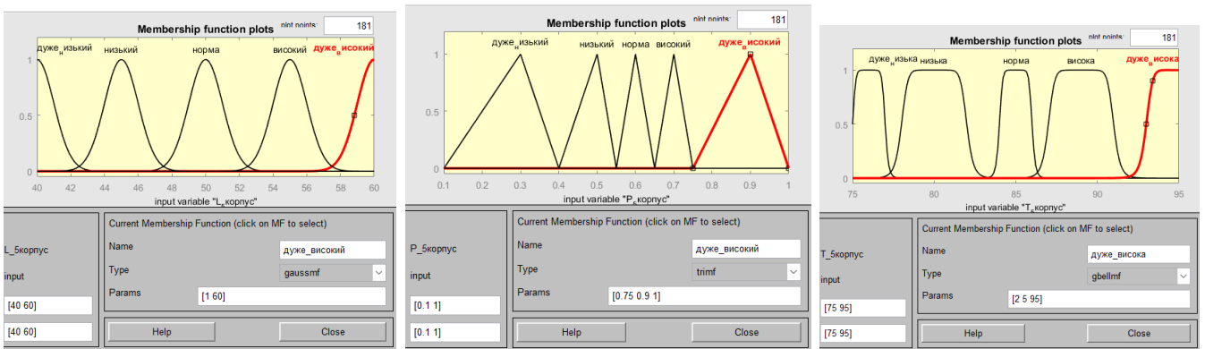
Рис.4.4.25. Лінгвістична змінна рівня, тиску та температури в V корпусі «дуже високий/дуже висока»
