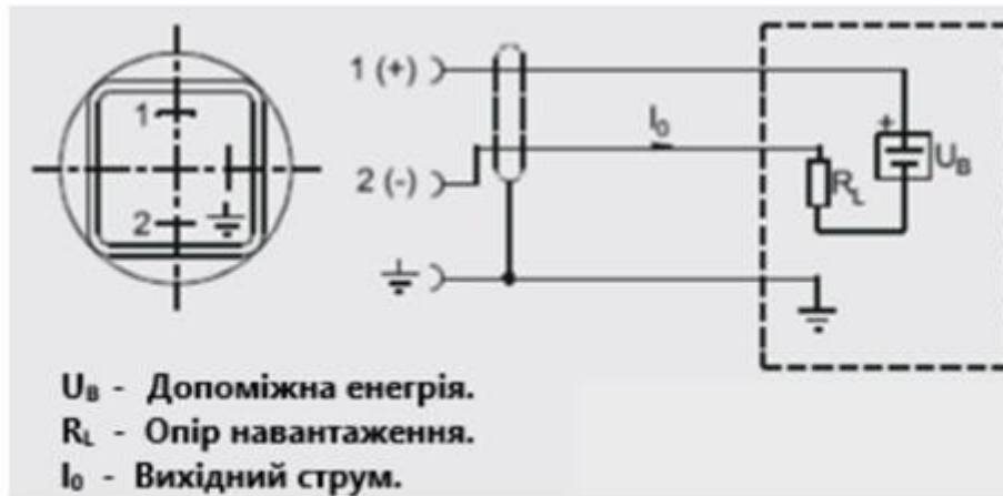
Рис.3.2.3. Схема підключення SITRANS TF2 до двопровідної лінії живлення
