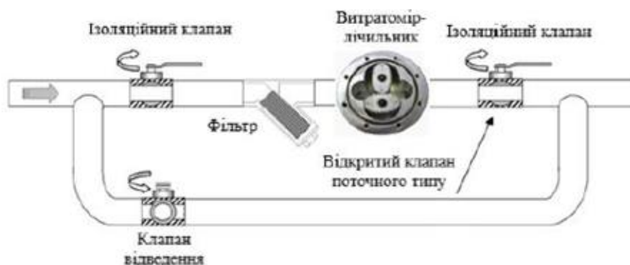
Рис. 3.2.12. Приклад експлуатації витратоміра-лічильника Kobold DOM
