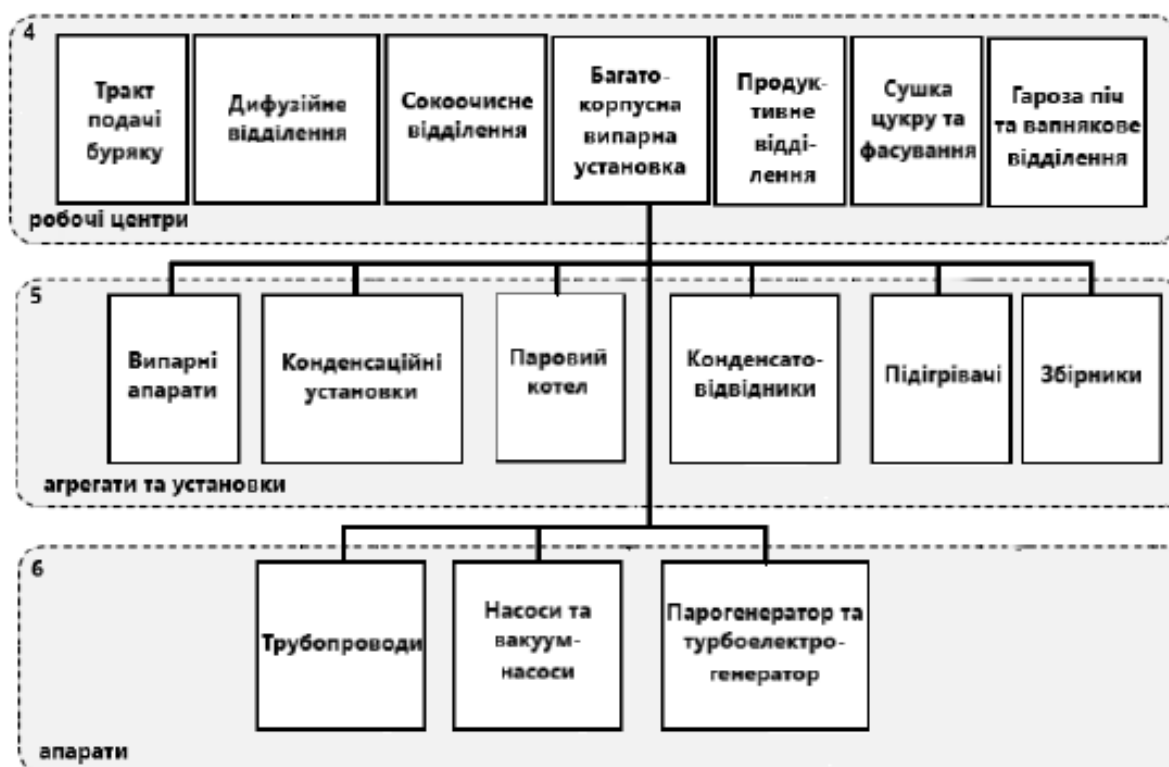
Рис. 2.8 Нижні рівні (4-6) ієрархічної моделі обладнання лінії виробництва цукру відповідно до ISA-95/106
