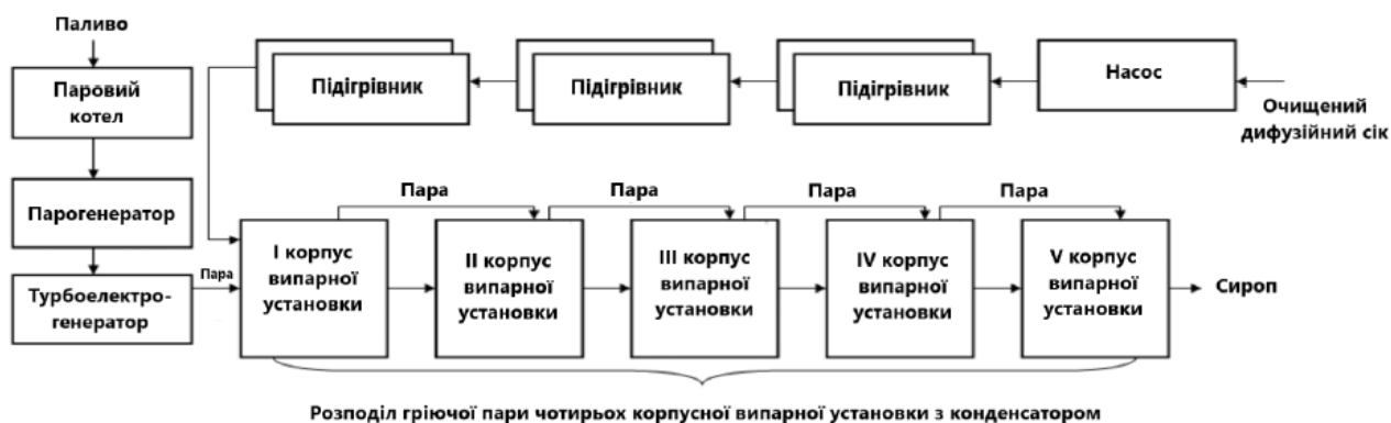
Рис. 2.1 Блок-схема роботи обладнання у випарній станції
