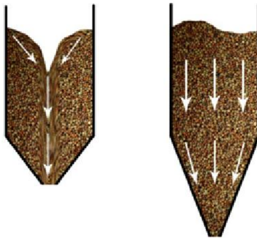
Рис. 2.1. Шаблони потоку; зліва: воронковий потік; праворуч: маса потік.
