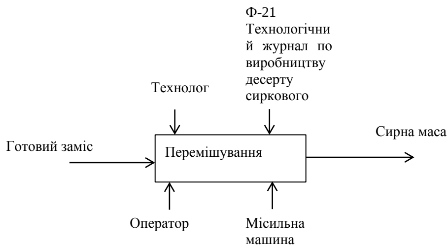
Рис. 8.15. Структурно-функціональна схема перемішування замісу
