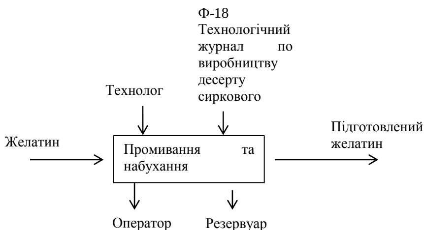
Рис. 8.13. Структурно-функціональна схема промивання желатину
