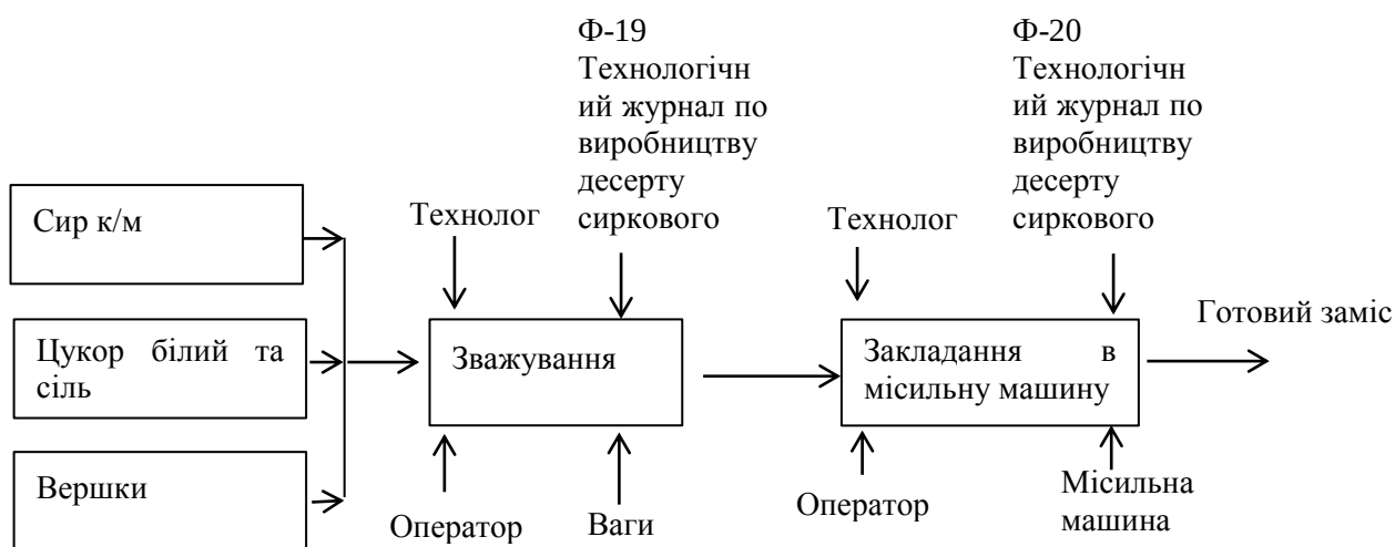
Рис. 8.14. Структурно-функціональна схема приготування замісу
