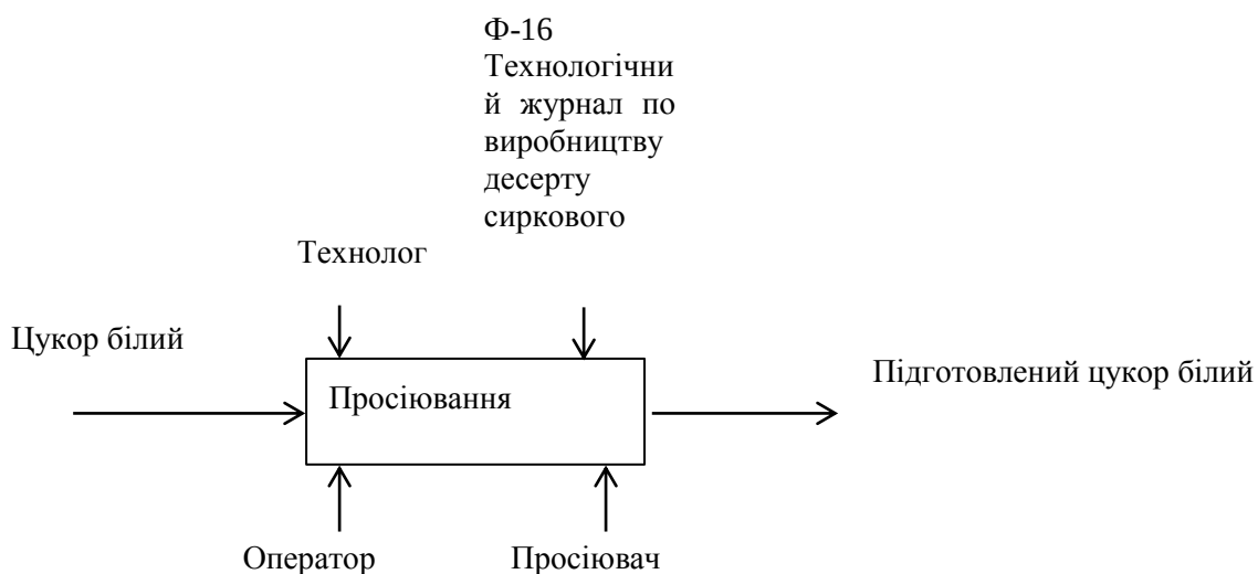
Рис. 8.11. Структурно-функціональна схема просіювання цукру білого
