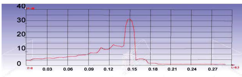
Рис.2. Залежності значень турбулентних дисипацій: а — існуюча форма ножа скребка; б — удосконалена форма ножа-скребка.
