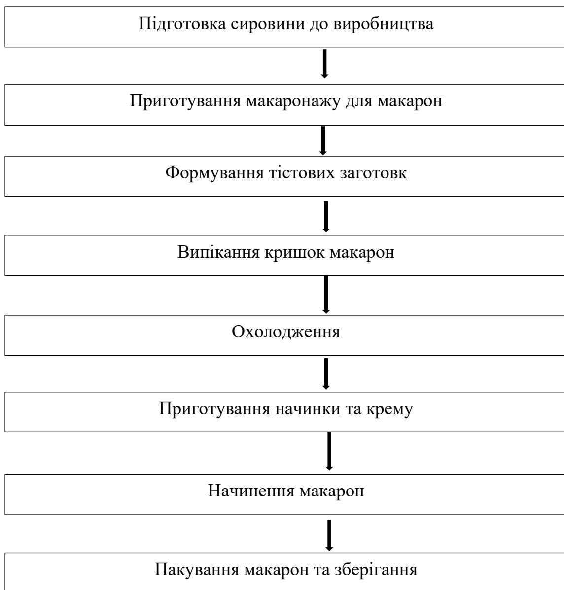
Рис. 1.3.4.1. Принципова схема виробництва тістечка макарон Функціональна схема технологічного процесу виготовлення тістечка макарон
