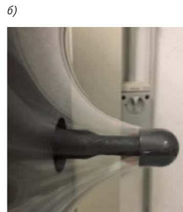
Рис. 4. Схема (а) та зразок стретч-плівки (б) при визначенні міцності утримування зусилля плівки при її розтягуванні
