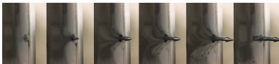
Рис. 5. Зразок стретч-плівки при визначенні її міцності на прокол
