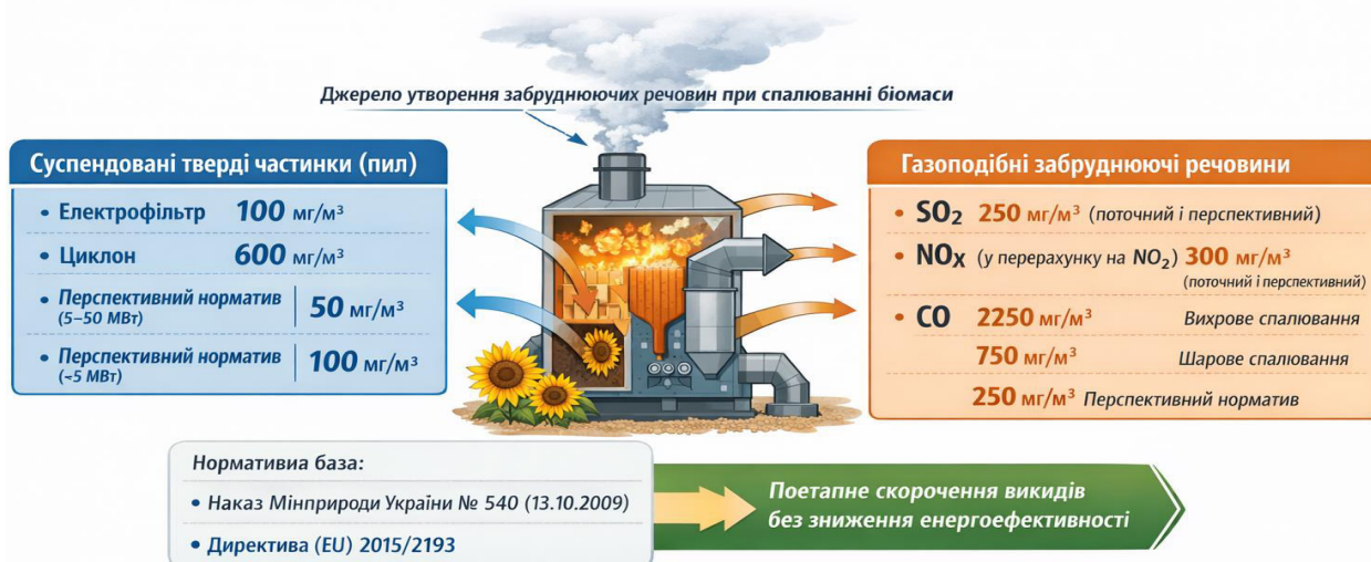
Рисунок 2.1 — Технологічні нормативи допустимих викидів забруднюючих речовин для котельних установок на лушпинні соняшнику (за наказом Мінприроди України № 540)
