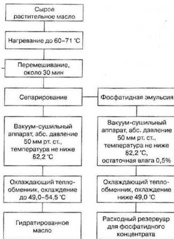
Рис.1.- Універсальна блок-схема процесу гідратації
