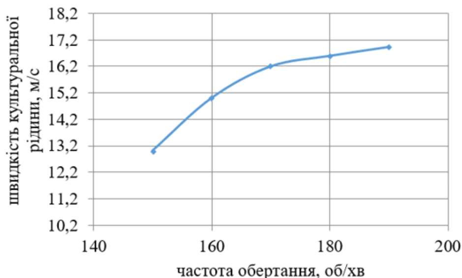
Рис. 3.7. Залежність швидкості руху середовища від частоти обертання пристрою перемішування
