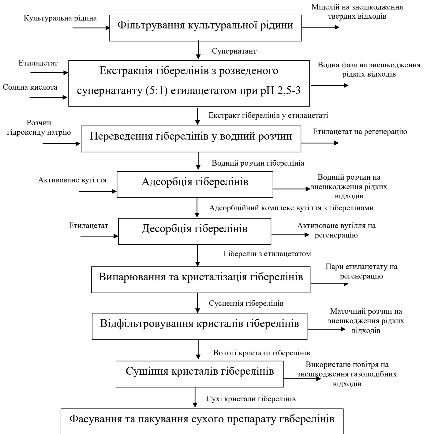
Рис.5.12. Схема виділення і очищення препарату гіберелінів
