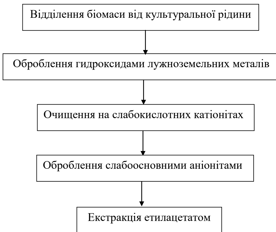
Рис.5.4. Схема виділення гіберелінів за допомогою хемосорбції іонітами
