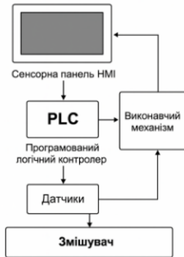
Рисунок 5.2 – Структурна схема автоматизованої системи керування змішувачем
