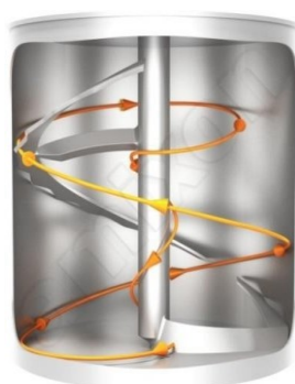
Рисунок. 1.8 - Вертикальний одновальний стрічковий змішувач
