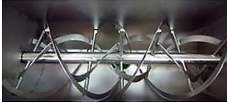
Рисунок. 1.7 - Вал з робочими органами типу «S»
