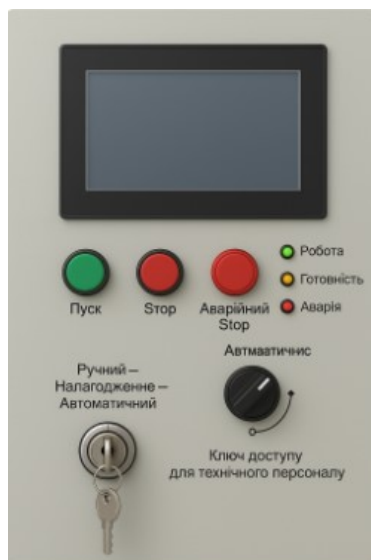
Рисунок 5.1 – Пульт керування змішувачем: сенсорна панель НМІ; кнопки «Пуск», «Стоп», «Аварійний Stop»; світлодіодні індикатори статусу; ручка-перемикач режимів «Ручний – Налаштування – Автоматичний»; ключ доступу для технічного персоналу.
