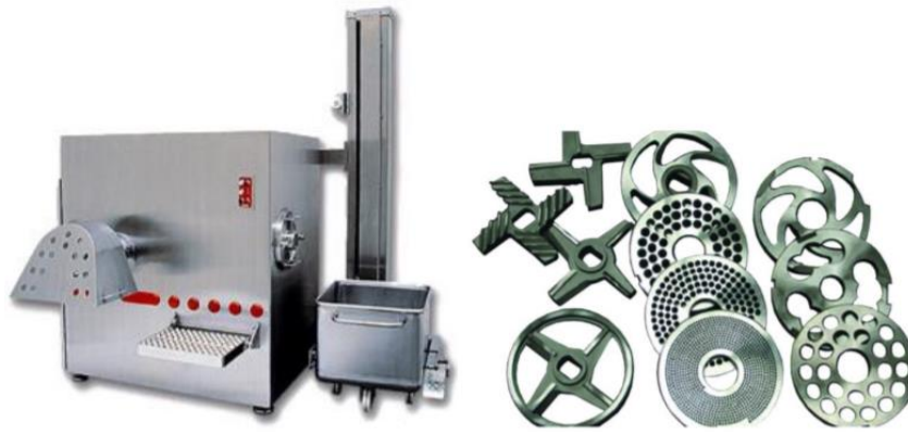
Рис. 4.2. - Вовчок Laska WW 160: а) – загальний вигляд вовчка; б) – деталі різального комплексу вовчка
